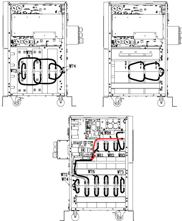
Схема размещения 16-ти АКБ в стандартной модели 10000 ВА.
