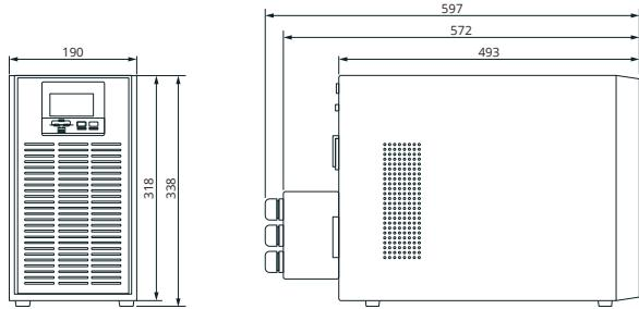
4. Стандартная модель 10000 ВА (со встроенными АКБ)
