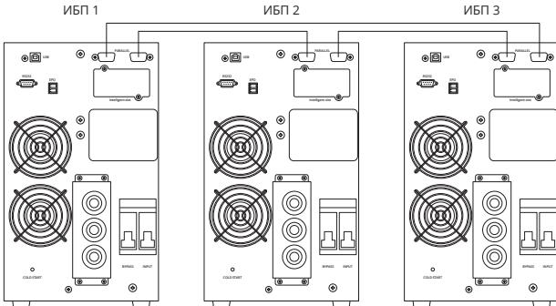
Рис. 2-4: 3 параллельных ИБП
