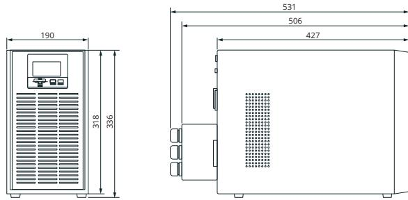
2. Стандартная модель 6000 ВА (со встроенными АКБ)
