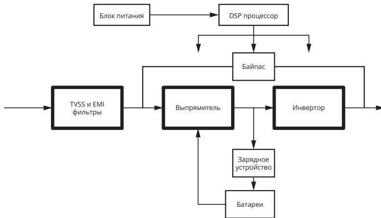
Рис 1-3: Система ИБП
