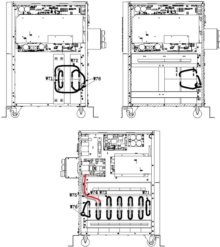
Схема размещения 20-ти АКБ в стандартной модели 10000 ВА.
